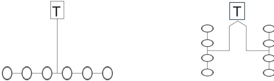
Instalación Recta: los accesorios funcionan en secuencia directamente desde el transformador.
